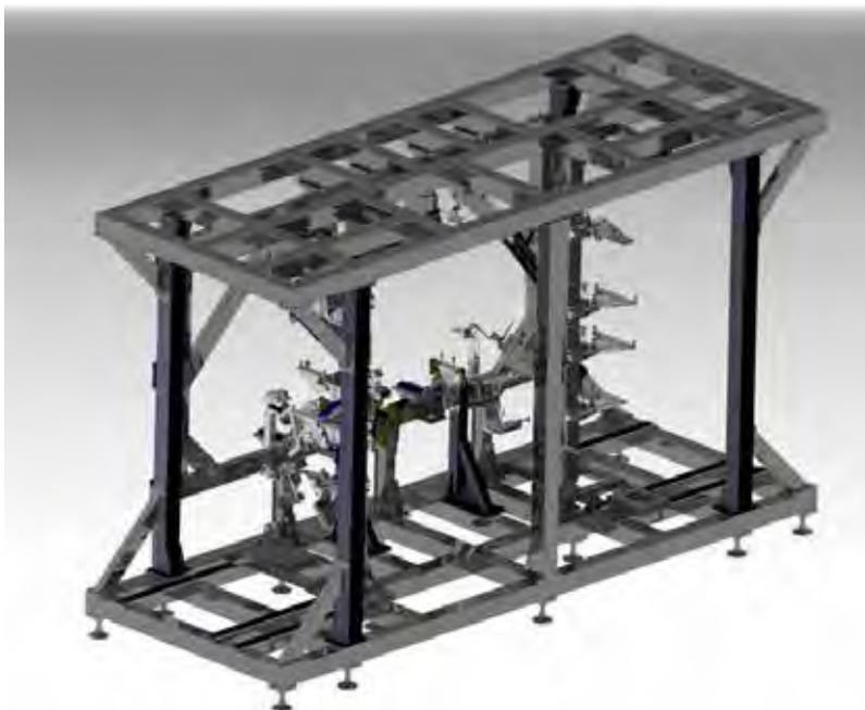
Scalo Assemblaggio sottoassieme M346
